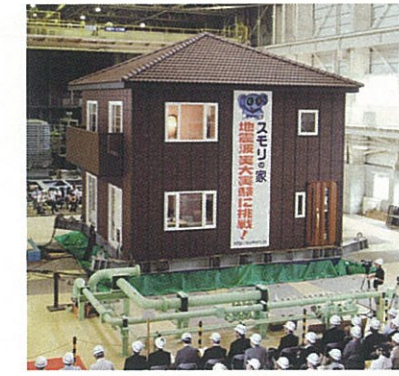
まず強固な六面体を作り、その上に屋根を乗せる構造。
